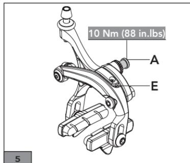
• Se i vostri freni sono dotati della vite di registrazione (E - Fig. 5), procedete alla correzione del centraggio (Fig. 6) per mezzo di un cacciavite Philips o di un cacciavite piatto.
